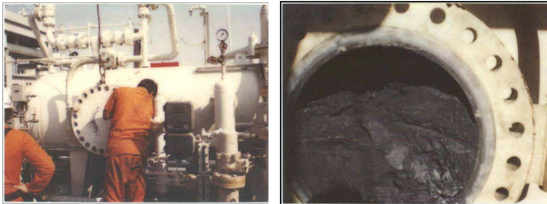
Depósitos de asfaltenos em separador de superfície, campo de Prinos, Greece (Leontaritis, 1987)
