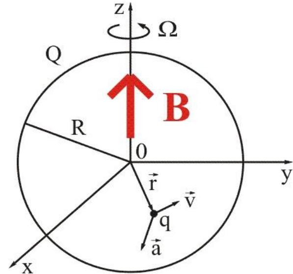
$$\vec{F}^{Lorentz} = q\vec{E} + q\vec{v} \times \vec{B} = q\vec{v} \times \frac{\mu_0 Q \vec{\Omega}}{6\pi R}$$
