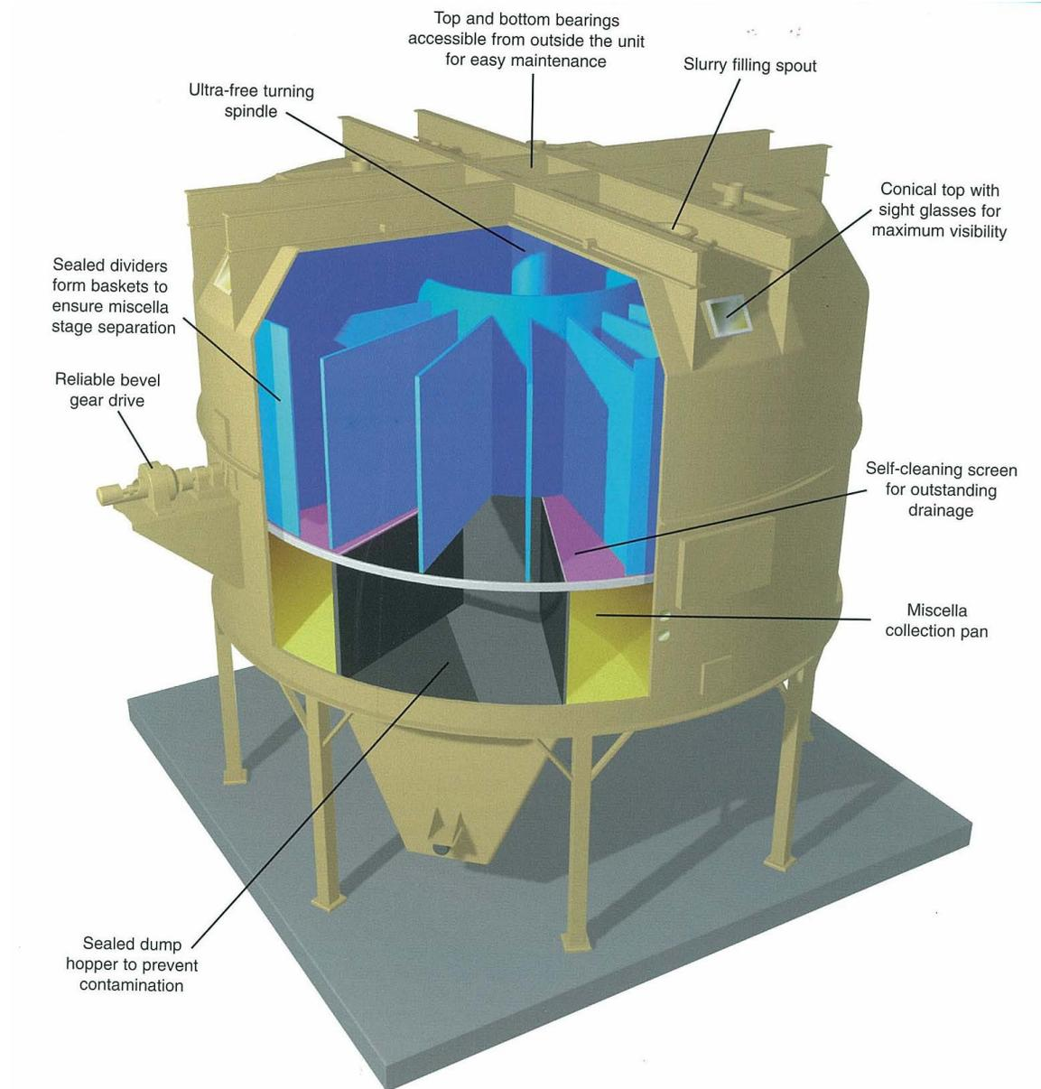
**Figure 14—INTERNAL VIEW OF A DEEP BED SOLVENT EXTRACTOR**
